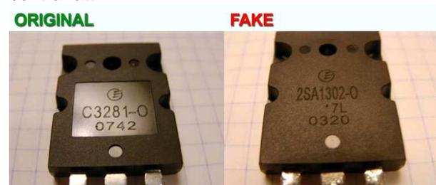
Figura1 – Due transistor: a sinistra l'originale, a destra quello contraffatto.
