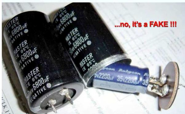
**Figura3** – La figura si commenta da sola... io personalmente, in quanto progettista elettronico, ho i brividi!
